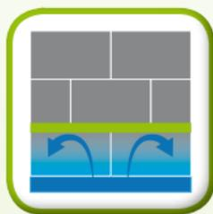
Grazie allo strato di Speedy Mix si interrompe la risalita di acqua dal sottosuolo, realizzando uno sbarramento orizzontale continuo (barriera chimica) in grado di eliminare definitivamente l'umidità di risalita nelle murature.
